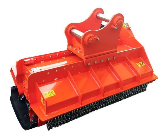
El cabezal triturador forestal TLE-FP es ideal para el corte de la hierba, cañas y arbustos hasta un máximo de 15/25cm de Ø cerca de zanjas, terraplenes y todos tipos de pendientes inclinados, de espacios sin cultivos y arboledas. El cabezal triturador TLE-FP se adapta a excavadoras con un peso a partir de 20 toneladas.
