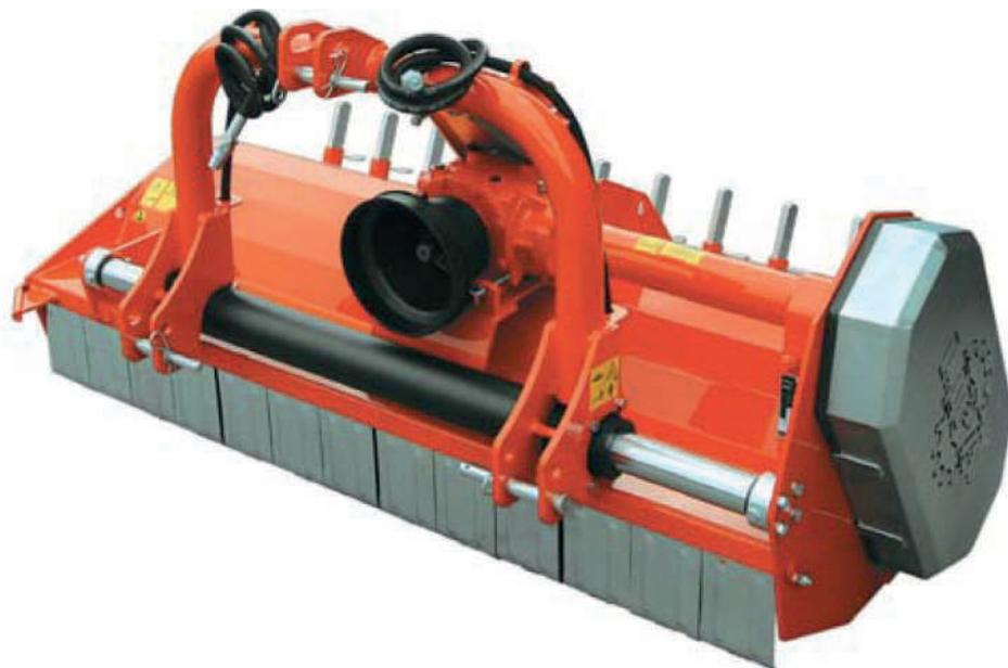
La desbrozadora TLSP es un aparato utilizado para la trituración de hierba, sarmientos, poda de viñedos, frutales y olivares. Está equipada con enganche de 3-puntos y se puede utilizar con tractores de orugas y de neumáticos. La desbrozadora TLS está caracterizada por el desplazamiento hidráulico (max 40 cm) que permite su uso en posición descentralizada para trabajos más cerca a los cultivos. (desplazamiento máquina pag. 45)
