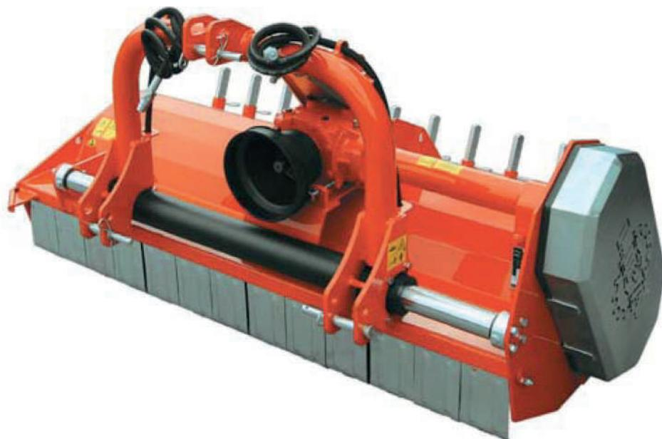
La hacheuse TLSP est un équipement utilisé pour le broyage de l'herbe et de sarments, de taille de vignes, des vergers et des oliviers. Il est équipé avec un attelage à 3-points et on peut l'utiliser avec tracteurs sur chenilles et sur roues. La hacheuse TLSP est caractérisée par le déplacement hydraulique (max 40cm) qui en permet l'utilisation en position décentrée pour travaux plus proches aux cultures. (déplacement machine pag. 45)
