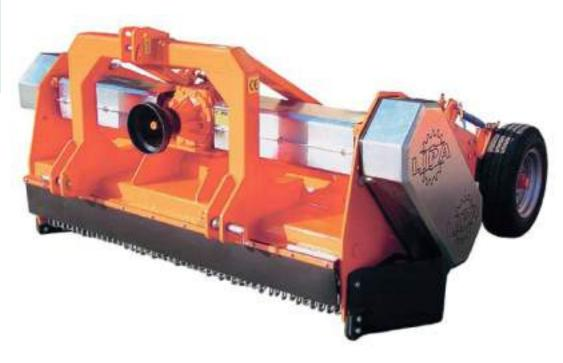
Il Trinciasassi TSL è ideale per la triturazione di ogni tipo di sasso di max 30cm. È adatto in agricoltura, nella costruzione delle strade, campi sportivi, piste da sci ecc. Può lavorare sia in superficie che in profondità.
